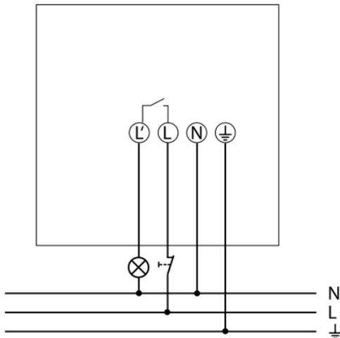
Mit einem Unterbrechertaster kann das Gerät manuell aktiviert werden. Nach Loslassen des Tasters (Spannungswiederkehr) schaltet das Gerät ein (für mind. 40 s bzw. für die am Gerät eingestellte Zeit).
