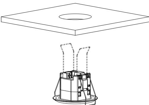
Einbau in Hohldecken für Deckenstärken von 0,5 mm bis 3 cm. Der Durchmesser des Deckenausschnitts muss zwischen 62 mm und 70 mm betragen.
