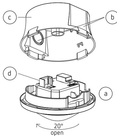
Sensorteil (a) um etwa 20° im Gegenuhrzeigersinn drehen bis zum Rastpunkt. Sensorteil abnehmen. Benötigte Ausbrüche (b) für die Kabeldurchführung vornehmen. Das Aufputzgehäuse (c) über die vorgesehenen Befestigungslöcher an die Decke montieren. Verdrahtung vornehmen (d). Sensorteil (a) aufbringen.
