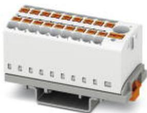
Verteilerblock, Block mit senkrechter Ausrichtung und integrierter Einspeisung. Die Blöcke sind untereinander über den Leiterschacht brückbar. Passende Steckbrücken siehe Zubehör, Nennspannung: 690 V, Nennstrom: 24 A, Anschlussart: Push-in-Anschluss, Push-in-Anschluss, Anzahl der Anschlüsse: 19, Querschnitt: 0,14 mm<sup>2</sup> - 4 mm<sup>2</sup>, AWG: 26 - 12, Breite: 28,6 mm, Farbe: weiß, Montageart: NS 35/7,5, NS 35/15
