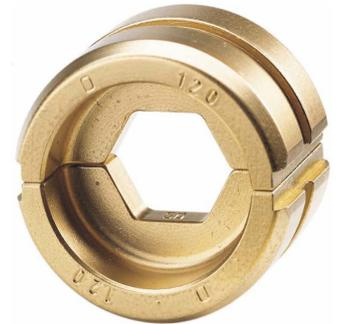
Presseinsätze zu den Werkzeugen 10 1868, 10 5501 und 10 5701 für Aluminium-Kabelschuhe und -Verbinder DIN 46239 und ähnliche Sechskantpressung, Pressbreite 7 mm - 185 mm<sup>3</sup>
