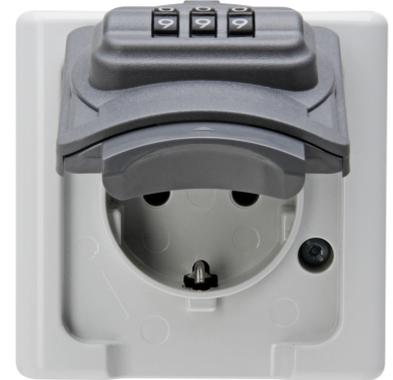
Aufputz-Feuchtraum Schutzkontakt-Steckdose mit Zahlenschloss, IP44, 16A, 250V~, BLUE ELECTRIC, grau. Die Sicherheitsverriegelung verhindert die unberechtigte Fremdnutzung, z.B. in Waschküchen. Frei wählbare Kombinationen, kein Schlüssel erforderlich, einfachste Lagerbevorratung, einfache Bedienung.
