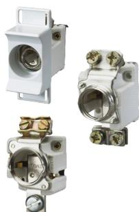
Das DO Sicherungs-System findet in Niederspannungs-Anlagen Anwendung, in denen die Sicherungs-Einsätze Laien zugänglich sind und durch diese ausgewechselt werden können. Es ist das modernste Schraub-Sicherungs-System und für 400VAC/250VDC ausgelegt. Die Baugrößen D01, D02 und D03 bilden das DO System.
