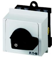
Umschalter, T0, 20 A, Verteilereinbau, 3 Baueinheit(en), Kontakte: 6, 60 °, rastend, mit 0-Stellung, 1-0-2, Abwicklungs Nr. 8212
