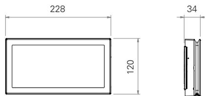
Maßangaben in mm (FlexiTech ED Deckenaufbaumontage)
