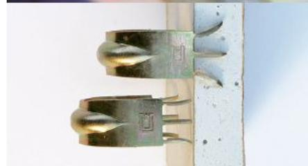
Mit der C-Fix-Schelle lassen sich Rohrleitungen schnell und bequem an Trockenbauwänden anbringen. Die einzigartige Formgebung sorgt für festen Halt und lässt die Außenseite der Wand unbeschädigt. Das flexible Installationsrohr (Schlauch) wird in die CF gesteckt, die CF mit dem Hammer eingeschlagen - fertig.
