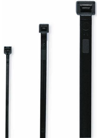
Kabelbinder aus Pa 6.6, schwarz, BxL 7,5x540 mm, Kabelbaum 20-160 mm, 460 N, Halogenfrei, UV-stabilisiert, Selbstverlöschend, Brennbarkeitsklasse UL94 V-2, Temperaturbeständigkeit -40°C bis 85°C. Zertifizierung: UL, RiNA, DNV, LR, Bureau Veritas.
