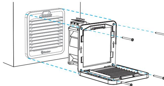
Die Installation ist durch die Rastnasen bis zu einer Wandstärke von 1.0...2.5 mm möglich. Bei anderen Wandstärken oder auftretenden Erschütterungen wird empfohlen, die Schrauben (im Lieferumfang) zu verwenden, Anzugsdrehmoment der Schrauben: 0.3 Nm.
