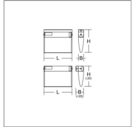
Leuchte zur Rettungswegkennzeichnung. Gehäuse Aluminium-Strangpressprofil pulverbeschichtet. Zum Einlegen für ein- und zweiseitige Verwendung sind 4 Rettungszeichenfolien und 1 weiße Folie beigelegt. Universal Befestigungssatz für Decken- und Wandanbau.
