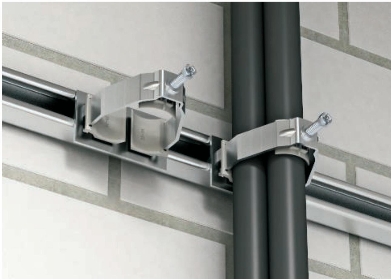
Mit Bügelchellen lassen sich Leitungen, Kabel und Rohre an Profilschienen befestigen. Bügelchellen sind in drei Standard-Fußformen erhältlich und können in die passenden Schlitzweiten der Profilschienen eingehakt werden. Das
