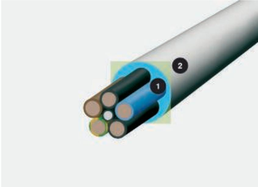
Kabeldurchmesser und Platzbedarf; 1 = Durchmesser in mm, 2 = Platzbedarf in cm<sup>2</sup>
