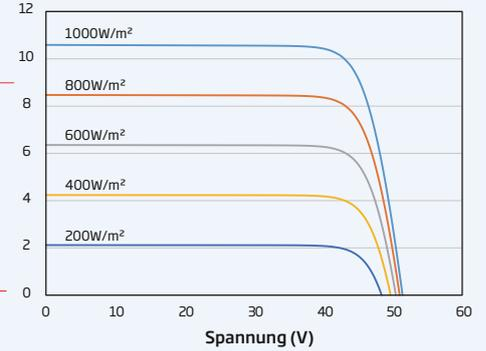
**P-V KURVEN DES PV-MODULS (430 W)**
