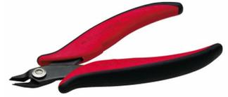
Elektronik-Seitenschneider bis 1, 3mm Durchmesser, 21 Grad, Länge 132mm
