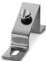
Schrägbügel mit Schraube M6, zur Befestigung der Tragschienen in einem Neigungswinkel von 30°, Höhe: 35,4 mm
