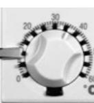
Istnieje możliwość określania górnego i dolnego limitu nastaw temperatury. Ograniczenia zakresu regulacji dokonuje się poprzez wyciągnięcie odpowiedniej blokady (rozmięsczone wokół skali). Ograniczenie może być ustalone ze skokiem co 5°C.
