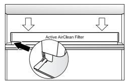
Setzen Sie die Halterung auf die Schutzleiste.
