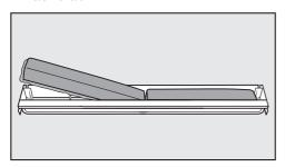
Entnehmen Sie die beiden Geruchsfilter und setzen Sie die neuen Filter mit dem umlaufenden Rand nach unten in die Halterung ein.
