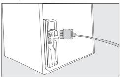
Stecken Sie den Gerätestecker auf der Rückseite des Kältegeräts ein.
