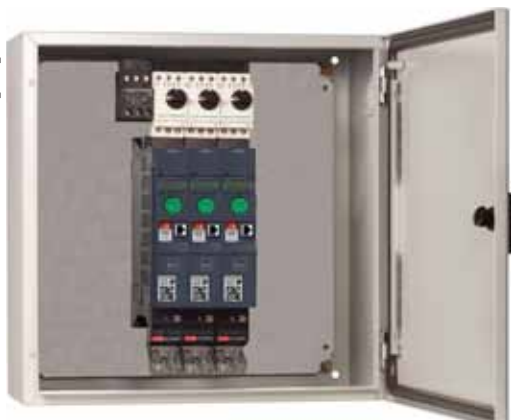
Beispiel für Direktmontage von GV2/ATV320 in einem Gehäuse: Leistungsschalter GV2L + Zubehör GV2454 und GV2G05 + Umrichter ATV320U15N4B
