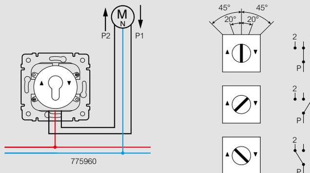
Mit montiertem DIN-Profil-Halbzyylinder (Best.Nr. 775888 oder 775889) kann das Schaltelement rechts (tastend/rastend) und links (tastend/rastend) betätigt werden.
