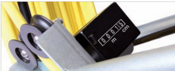
MECHANISCHES ZÄHLWERK mit gehärtetem Rändelrad. 5-stelliges Rollenzählwerk mit Meter und 10 cm Anzeige. Standard bei allen Haspeln Ø 730 mm - Ø 1000 mm - Ø 1400 mm mit Glasfaserstäbe Ø 7,5 mm - Ø 9 mm - Ø 11 mm - Ø 15 mm
