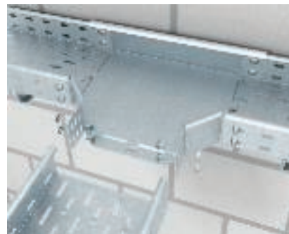
Montage T-Abzweigstück (Breite 100 - 300 mm) Das T-Abzweigstück in den Breiten 100 bis 300 mm wird einseitig in den Holm und auf der anderen Seite über den Verbinder geschoben. Im Bereich der Formteile sollten weitere Unter- stützungen vorgesehen werden.
