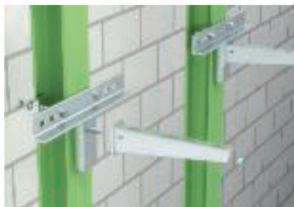
Klemmbefestigung an senkrechtem Stahlträger Montage der Adapterplatte Typ KA-AW an senkrechtem Stahlträger mittels Klemmwinkeln oder Spannpratzen. An der Adapterplatte werden Wandausleger Typ AW mit der Sechskantschraube Typ SKS 12x40 GF befestigt.
