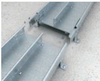
Trennstegmontage Montage eines Trennstegs innerhalb der Trasse zum Trennen von Kabeln und Leitungen bzw. Stromkreisen sowie zur zusätzlichen Stabilisierung des Deckels ab einer Breite von 400 mm.
