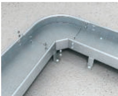
Montage Bogen Bögen der Breite 100 bis 300 mm werden einseitig in den Holm und auf der anderen Seite über den Verbinder geschoben, bei Breiten 400 bis 600 mm werden Standard-Verbinder benötigt.
