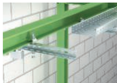
Kragträger an Stahl Montage von U-Stiel als Kragträger an Stahlträger. Befestigung je nach Belastung mit Klemmwinkeln oder Spannpratzen. Befestigung mit Distanzstücken Typ DSK.
