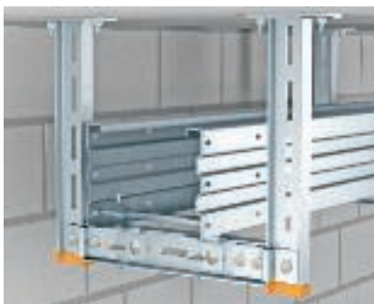
Montagebeispiel Doppelseitige Hängestielmontage aus I-Profilen mit Quertraverse. Befestigung einer Weitspannkabelleiter Typ WKL 200 mit Klemmstück Typ LKS 60/5 auf dem Querprofil.
