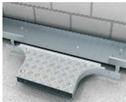
Montage Anbau-Abzweigstück Für die Montage des Anbau-Abzweigstücks Typ RAA wird der Holm der Kabelrinne ausgetrennt und das Anbau-Abzweigstück eingefügt.
