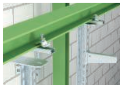
Klemmbefestigung mit zusätzlichem C-Profil Einsatz einer zusätzlichen C-Profilschiene Typ CPS bei breiteren Stahlträgern. Trassenverlauf längs zum Stahlträger.
