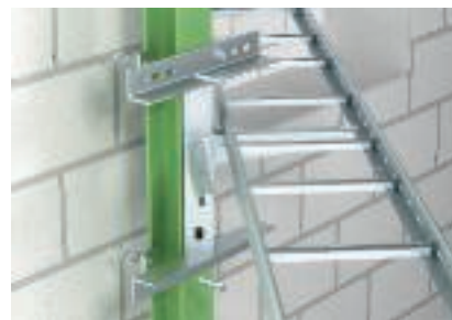
Adapterplatte 45°, Stahlklemmung Montage der Adapterplatte 45° Typ KA-E 45 an Stahlträger mittels Klemmwinkeln oder Spannpratzen. Zur zusätzlichen Unterstüzung bei Trassenverläufen an Winkeln und Raumecken.
