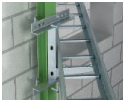
Adapterplatte 45° Montage der Adapterplatte 45° Typ KA-E 45 mit Klemmwinkel Typ KWS an Stahlträger. Die Montage der Adapterplatte kann mit Bolzenankern auch an Betonwänden erfolgen.
