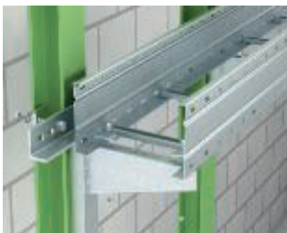
Wandausleger schwer Montage des schweren Wandauslegers Typ AWSS mit Klemmwinkel Typ KWS an Stahlträger zur Aufnahme eines Weitspann-Systems. Die Montage des Wandauslegers kann mit Bolzenankern auch an Betonwänden erfolgen.
