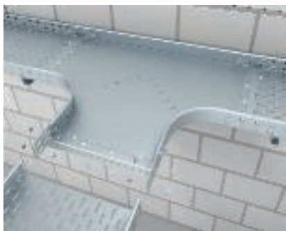
Montage T-Abzweigstück (Breite 400 - 600 mm) Das T-Abzweigstück in den Breiten 400 bis 600 mm wird mit Verbindern und Stoßstellenleiste mit der Kabelrinne verbunden. Im Bereich der Formteile sollten weitere Unter- stützungen vorgesehen werden.
