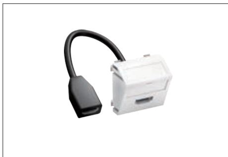
Multimediaträger mit einer HDMI Anschlussbuchse, Kabelauslass schräg, mit Beschriftungsfeld, kurzes HDMI Anschlusskabel in Ausführung Buchse-Buchse. Trägerplatte mit Rastbefestigung, geeignet für den waagerechten und senkrechten Einbau in die Systemumgebung.
