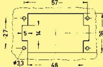
**Schraubanschluss mit Drahtschutz**
