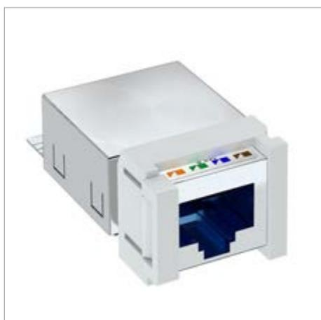
Anschlussmodul Kat. 6 geschirmt, mit einem RJ45-Steckplatz. Inklusiv einer EMV-Schirmhaube, einer Staubschutzkappe, einem Kabelbinder, einem Snap-In Befestigungsrahmen und einer Montageanleitung. Geeignet für den Einbau in Trägerplatte Typ MTM 2C und MTM 3C, Montageplatte Typ MPR2 2C, Montageträger Typ MTGE2 2C, MTGE2 15 2C und MTGE2 F 2C.
