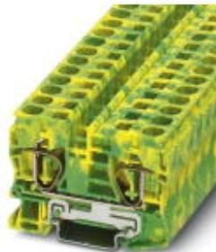
Schutzleiter-Reihenklemme, Anschlussart: Zugfederanschluss, Querschnitt: 0,2 mm<sup>2</sup> - 16 mm<sup>2</sup>, AWG: 24 - 6, Breite: 10,2 mm, Farbe: grün-gelb, Montageart: NS 35/7,5, NS 35/15
