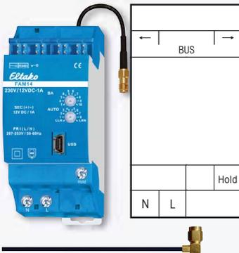
**Funk-Antennenmodul für den Eltako-RS485-Bus mit austauschbarer Antenne. Mit integriertem Schaltnetzteil 12V DC/12W. Bidirektional. Verschlüsselter Funk. Stand-by-Verlust nur 1 Watt. Bei Bedarf kann eine Funkantenne FA250 oder FA200 angeschlossen werden.**
