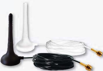
Die kleine beiliegende Funkantenne der Funk-Antennenmodule FAM14 kann für die Einleitung der Funksignale in Metall-Schaltschränke durch eine größere Antenne ausgetauscht werden. Diese wird mit einem Magnetuß extern angebracht. Das Kabel wird nach innen bis zu dem FAM14 geführt.
