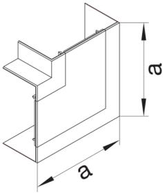
**Flachwinkel für Brüstungskanal BRP/BRHP/BRAP 65x130mm halogenfrei verkehrsweiß**
