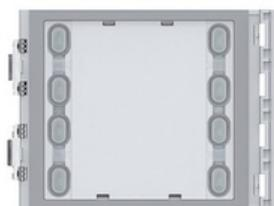
Ruftasten-Modul mit 8 Ruftasten (2-reihig) zur Verwendung mit den Audio-Türlautsprecher-Modulen Art. 351000–351100 bzw. mit den Video-Lautsprechermodulen Art. 351200–351300. Anschluss weiterer Ruftasten- oder Infomodule über das mitgelieferte Verbindungskabel. Anmerkung: Bei Verwendung dieses Ruftastenmodules muss bei den Lautsprechermodulen Art. 351100-351200-351300 der Jumper (J1) gezogen werden.
