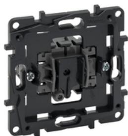
Die Niloe Step Einsätze sind für Spreizkrallen- und Schraubbefestigung geeignet und werden mit roter Staubschutzabdeckung geliefert. Verwendbar für den Anschluss von starren und flexiblen Leitern mittels Steck- (SL) oder Schraubklemmen (SK). Zu komplettieren mit Wippen und Abdeckrahmen von Niloe Step. Wechselschalter, 1-polig (SL), 16 AX – 250 V~, Beleuchtbar mit LED Best.Nr. 764526 oder Kontrollfunktion mit Best.Nr. 764521.
