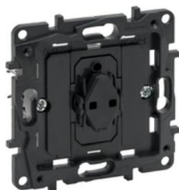
Die Niloe Step Einsätze sind für Spreizkrallen- und Schraubbefestigung geeignet und werden mit roter Staubschutzabdeckung geliefert. Verwendbar für den Anschluss von starren und flexiblen Leitern mittels Steck- (SL) oder Schraubklemmen (SK). Zu komplettieren mit Wippen und Abdeckrahmen von Niloe Step. Niloe Step Rollladen-/Jalousietaster (SL) 6AX 250 V~ Für den direkten Anschluss an Rollladenmotoren. Nicht beleuchtbar.
