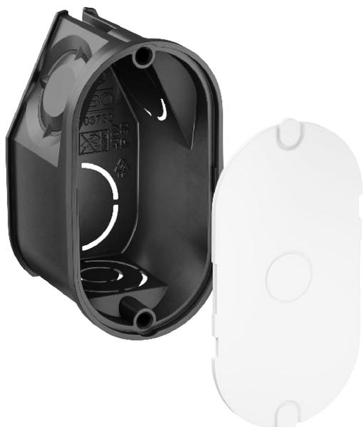
Unterputz-Wandauslassdose zur Einzelkabelverlegung. Ovale Form, für den Einsatz in Mauerwerk mit einer Einbautiefe von mindestens 30 mm.
