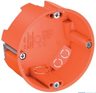
Hohlwand-Gerätedose für den Einsatz in Hohlwänden mit einer Einbautiefe von mindestens 35 mm und einer Plattenstärke von 5 - 28 mm.
