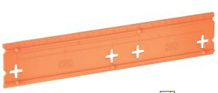
Bohrschablone für Unterputz- und Hohlwanddosen. Zum Anzeichnen der Befestigungsabstände von 71 oder 91 mm. Mit Markierungshilfen zum Vorkörnen und mit Kerben zum Ausrichten an z. B. Schlagsschnurmarkierungen.
