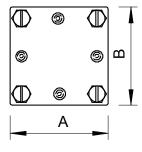
Maß A Maß B Art der Befestigungsschraube Art des Verbinders Blitzstromtragfähigkeit Geeignet für Verbindung Passung 80,00 mm 80,00 mm Sechskantschraube Kreuzverbinder H/100 kA Flachleiter Fl 40 / Fl 40 max. FL40 mm
