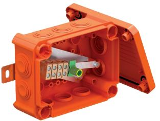
Verbindungskasten mit weichen Einsteckdichtungen. Ausreichender Verdrahtungsraum durch diagonal angeordnete Anschlusseinheit mit komplett vormontierten hochtemperaturbeständigen Keramikklemmen. Grün-gelb gekennzeichnete Schutzleiterklemme. Befestigung an gut zugänglichen Außenlaschen. Zugelassen für Kabelanlagen mit elektrischem Funktionserhalt nach DIN 4102 Teil12 mit den Klassen E30, E60 und E90.
