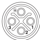
Polbild M12-Buchse, 4-polig, S-kodiert, Ansicht Buchsenseite
