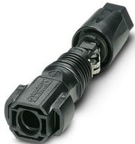
Photovoltaik-Steckverbinder, Artikelfamilie: Sunclix, Steckverbinder, Material Gehäuse: PPE, Farbe: schwarz, Polzahl: 1, Aderquerschnitt min.: 2,5 mm<sup>2</sup>, Aderquerschnitt max.: 6 mm<sup>2</sup>, Bemessungsspannung: 1100 V DC, Bemessungsstrom: 35 A, Anschlussart: Federkraft, Kontaktart: Stift, Kabeldurchmesser min.: 5,5 mm, Kabeldurchmesser max.: 8 mm. Nachfolgeartikel von 1774687
