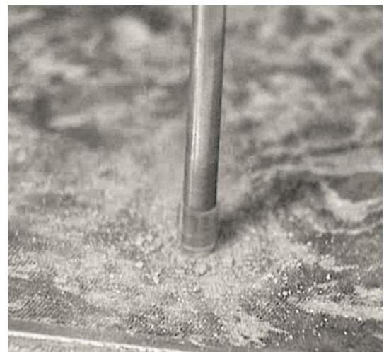
Der LB Lanzenbohrer ist ideal auch für Fliesen und Keramik.
