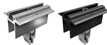
Mittelklemmen Vario mit Erdungspin für Rahmenhöhe 30 mm - 50 mm
