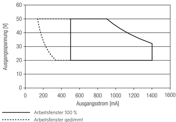
Es ist sicherzustellen, dass der LED-Driver ausschließlich innerhalb des gezeigten Arbeitsfensters betrieben wird. Besondere Aufmerksamkeit ist dem gedimmten Betrieb sowie dem DC- und Notlichtbetrieb zu widmen, da aufgrund der verwendeten Amplituden-Dimmung die Modulspannung mit dem Dimm-Level variiert. Eine Unterschreitung der spezifizierten minimalen Ausgangsspannung des LED-Drivers kann zur Abschaltung führen. Siehe Abschnitt „6.8 DC- und Notlichtbetrieb“ für mehr Informationen.
