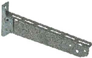
Ausleger, Breite: 100 mm, passend für Hängestiel U50/U55/U60 und Profil U50/U55/60 oder direkt montierbar an der Wand, Befestigung am Profil U50/U55 mit 1x M8 x 20 mm, Flachrundschräube + Beilagscheibe + Sechskantmutter, sendzimirverzinkt
