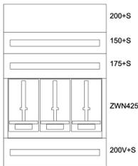
Montageinsatz für Zählerverteiler, B=720mm, H=1150mm, 3 Zählerplätze
