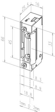
Modell mit mechanischer Entriegelung (Tagesentriegelung).
