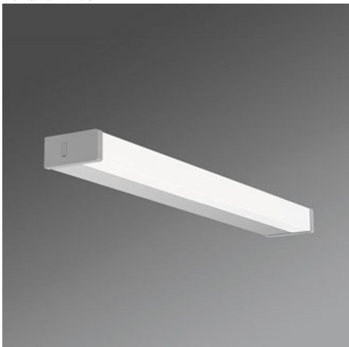
Möbelleuchte/Spiegelleuchte; Gehäuse Aluminiumstrangpressprofil eloxiert, verschraubbare weisaluminium lackierte Stirnseiten aus Kunststoff, Befestigung senkrecht oder waagrecht als Wandmontage möglich, mit integrierten Kabelkanal und schutzartgerechter Leitungseinführung. Gehäusefarbe aluminium natur eloxiert; Lichtverteilung direkt/indirekt mittels opalem Diffusor aus Polycarbonat mit glatter Oberfläche; Elektrischer Anschluss über dreipolige Anschlussklemme in Steckkontakt-Technik.
